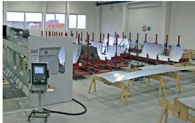
5-Achsen-Bearbeitung von sphärisch verformten Bauteilen für die Luftfahrtindustrie
